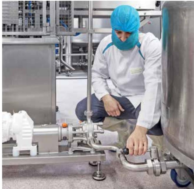
MasoSineのCertaは繊細な食品および飲料用途でロータリーポンプに勝る性能を発揮します。MasoSineポンプのサインロータ設計は、繊細な食品製品を劣化させることなく安全に移送する、低せん断で穏やかなポンプ動作を実現します。
