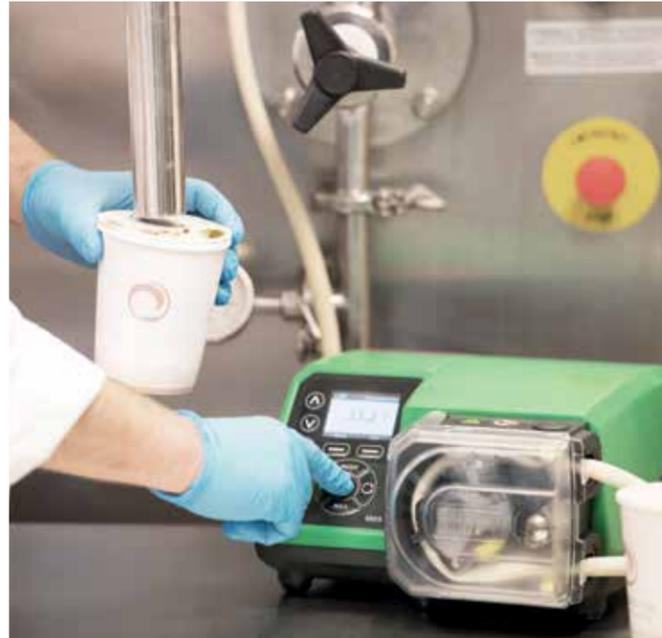
チューブポンプはせん断の影響を受けやすい腐食性流体を移送できます。移送される流体はチューブ内に完全に收容されるため、流体は完全に分離され、クロスコンタミネーションが発生しません。
