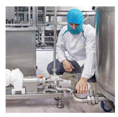
Nelle applicazioni critiche del settore alimentare, la pompa Certa di MasoSine supera le prestazioni delle pompe a lobi. Il design della nostre pompe MasoSine, basato sul principio del rotore sinusoidale, garantisce sollecitazioni di taglio ridotte e un'azione di pompaggio delicata che trasferisce in maniera sicura prodotti alimentari più sensibili senza il rischio che si rovinino.
