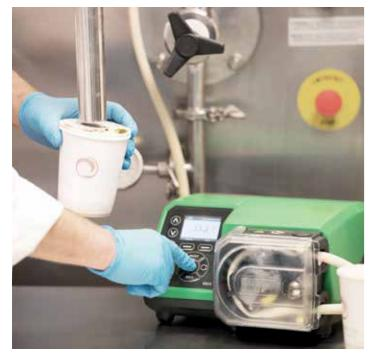
Le pompe peristaltiche sono in grado di gestire fluidi aggressivi e sensibili al taglio. Il fluido pompato è contenuto interamente nel tubo, garantendo il totale isolamento e nessuna contaminazione incrociata.
